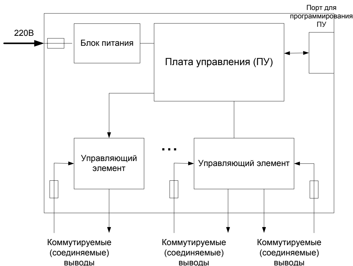
Рис. 1. Внутренняя функциональная схема контроллера.
